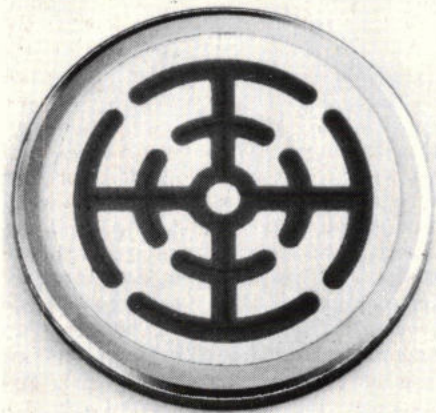
Afb. 6b Schoonheid in de techniek. De vorm van het stuurcontact van de supersnelle thyristor T 178 S doet enigszins aan het werk van een goudsmid denken. Met deze constructie werd het mogelijk de uitbreidings tijd van de ontsteking ten opzichte van een normale thyristor van dezelfde grootte met circa 50% te bekorten. De T 178 S is bedoeld voor gebruik bij frequenties tot circa 10 kHz, bijvoorbeeld in frequentieconverters voor inductieve verhitting.
